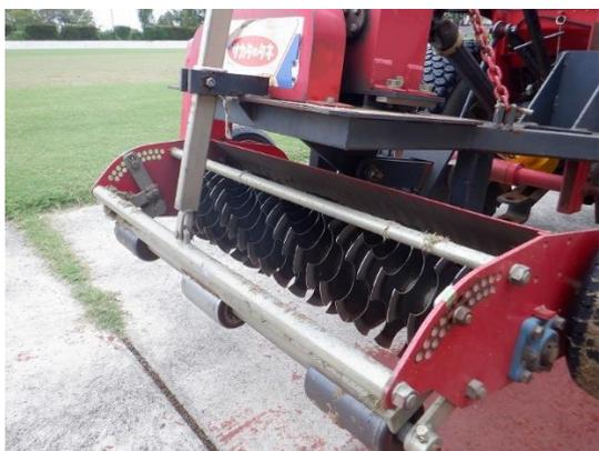
▲機械にはたくさんの刃が付いていて高速回転してサッチを掻き出します。
