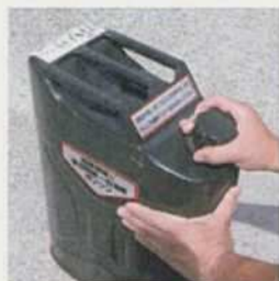
①元のネジ部を少し緩め 缶内の圧縮空気を抜く。
